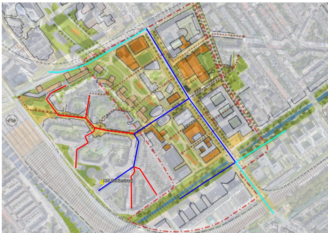
Figuur 1 | Schets van een collectief lage temperatuur net voor het Beatrixkwartier. In het blauw is de lage temperatuur backbone gegeven. Aan deze backbone kunnen opslagsystemen (WKO) gekoppeld worden en lage temperatuur bronnen zoals uitkoppeling van warmte bij het rioolgemaal Schiestraat. Het net is makkelijk uitbreidbaar richting bijvoorbeeld centrum en Binckhorst (turquoise lijnen). Voor bestaande bouw zou een midden temperatuur net (rode lijnen) gekoppeld kunnen worden aan het lage temperatuur net. Voorliggende illustratie is een schets ter indicatie en inspiratie en geen ontwerp.
